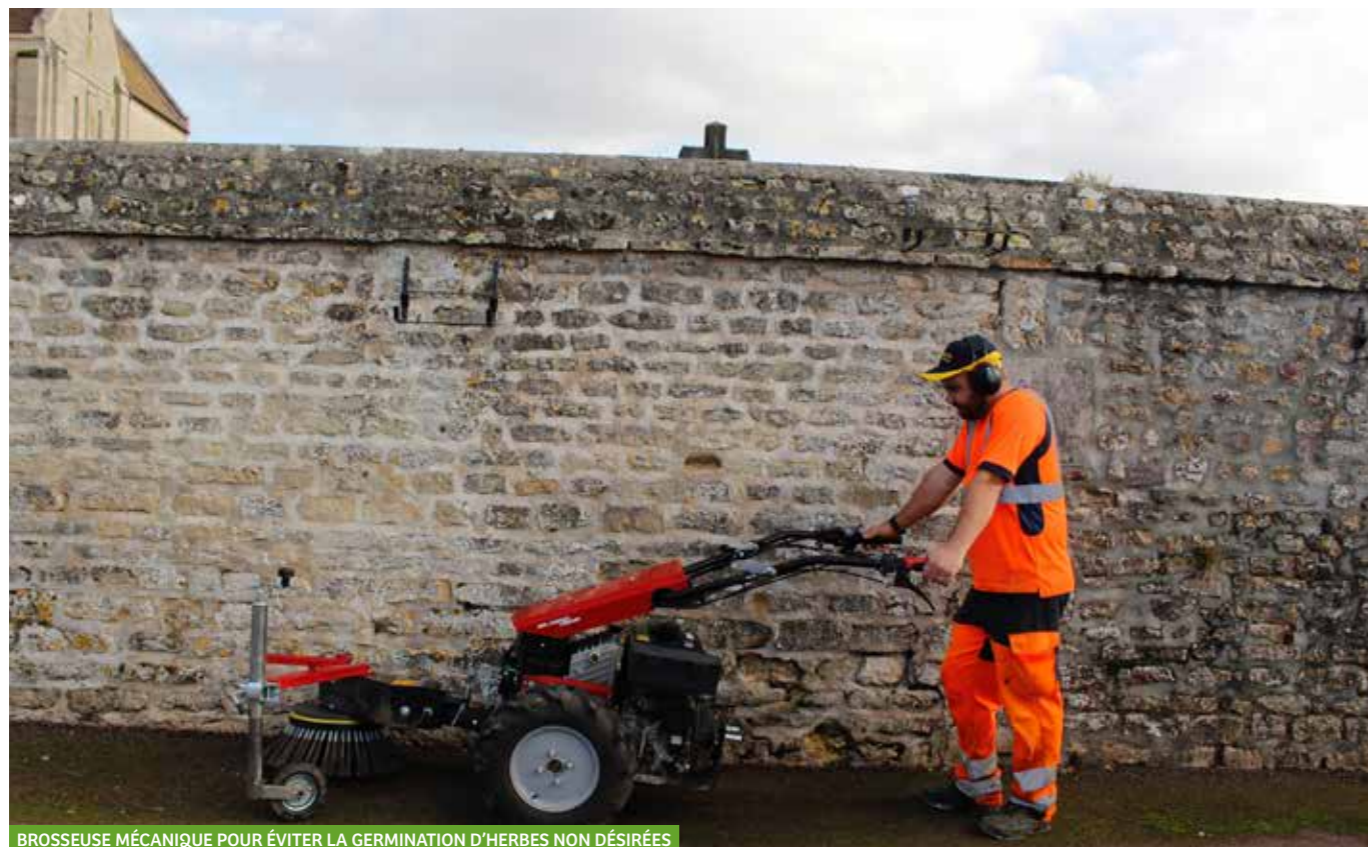
BROSSEUSE MÉCANIQUE POUR ÉVITER LA GERMINATION D'HERBES NON DÉSIRÉES
